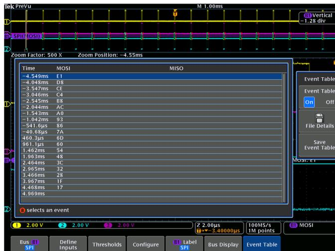
SPI 总线事件表，捕获的所有包都带有时间标记，并采用表格视图。
