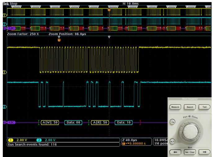
搜索 - I<sup>2</sup>C 解码显示地址值 50 的 Wave Inspector 搜索结果。Wave Inspector 控件在波形数据的显示和导航方面提供了前所未有的高效率。
