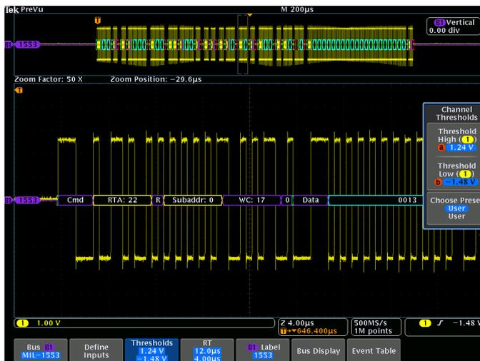
MIL-STD-1553 总线设置，显示门限输入字段。
