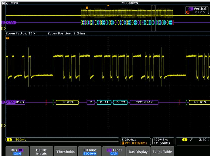
CAN 总线带颜色编码的显示画面，显示串行信号的开始、DLC、数据、CRC 和停止成分。
