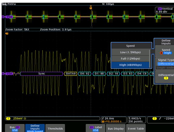
高速 USB 解码后的显示画面，自动显示总线内容。
