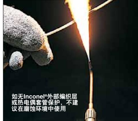
如无Inconel®外部编织层或热电偶套管保护, 不建议在磨蚀环境中使用
