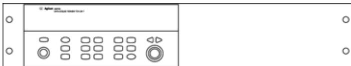
要将该仪器安装在机架中, 请订购安装套件 5063-9240(选件 1 CM)。
