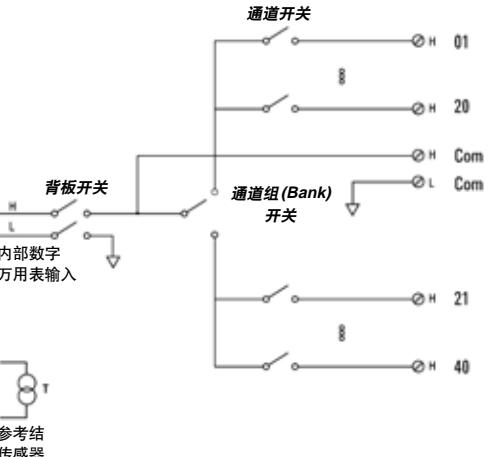
注: 热电偶必须彼此绝缘，以免形成电流环路，从而产生测量误差。
