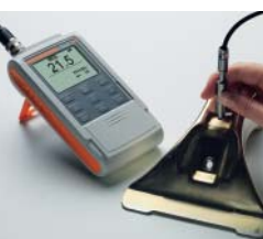
DELTASCOPE® FMP10 – 配合FGAB1.3探头测量铁上镀锌层。
