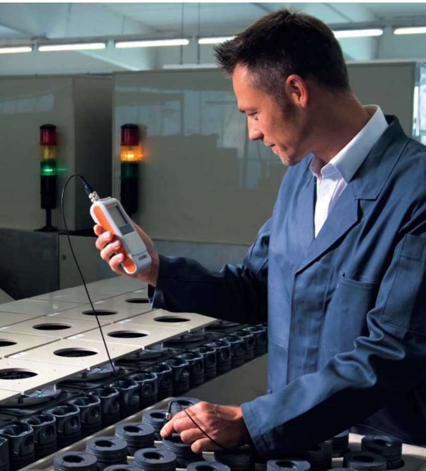
使用FTA3.3H 探头对刚生产出来的引擎活塞进行质量检测。
