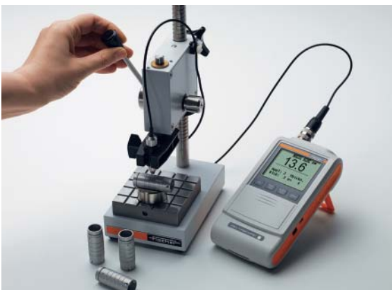
DUALSCOPE® FMP40配合FGA2H 探头和工作台使用，在夹具的定位下测量圆柱形工件。
