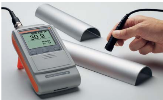
DUALSCOPE® FMP20 配合获得专利的曲率补偿探头FTD3.3测量阳极氧化样品。
