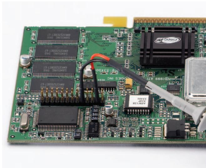
图 7. 双线适配器可使您轻松地将 N2870A 系列探头与常用的采用 0.025" 四方针的 0.1 英寸排针连接。该双线适配器不会有短路危险，因为所有外部金属表面都是绝缘的。
