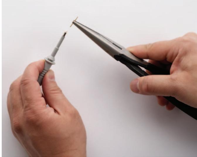
图2. 尖锐的探针可轻松地探测目前的微细间距元器件
