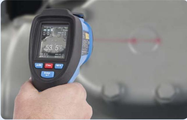
在非接触测量模式下，测温仪通过热敏传感器检测从物体辐射出来的热能。将红外测温仪指向目标物体，热敏传感器将收集能量并产生信号，最后经微处理器转换为背光显示屏上的读数。
