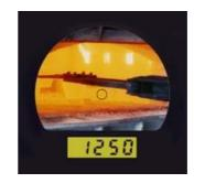
精确的光学反射系统提供了一个很窄的视场(98%辐射能),在距离被测物体 1 米时,最小测量目标直径为 4.8 毫米。使用近焦距镜头时,被测目标的直径可以小到 0.4 毫米(见上右图)。
