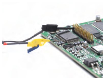
IC 夹包括适用于 N2870A 系列无源探头的 N2877A 和 N2878A 附件套件
