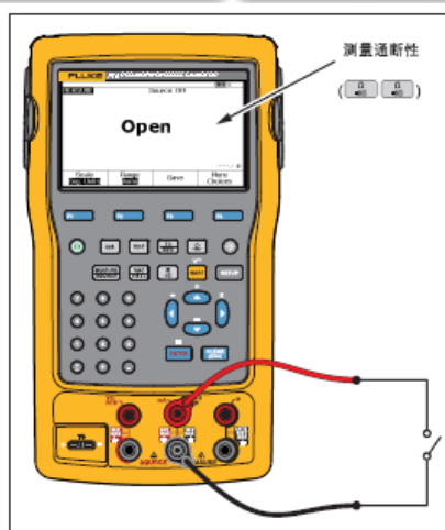
开关通断检查
