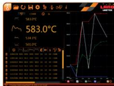
表视图显示温度瞬时值、谷值、平均值和峰值，以及独特的 Meltmaster（在 O55 L 型号上）读数。
