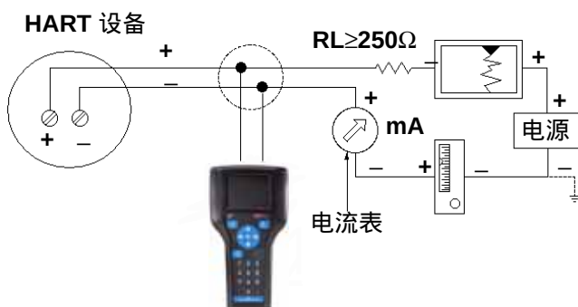
图 3-3. 连接到 HART 设备
