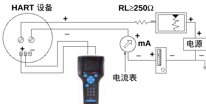
图 3-4. 直接连接到 HART 设备
