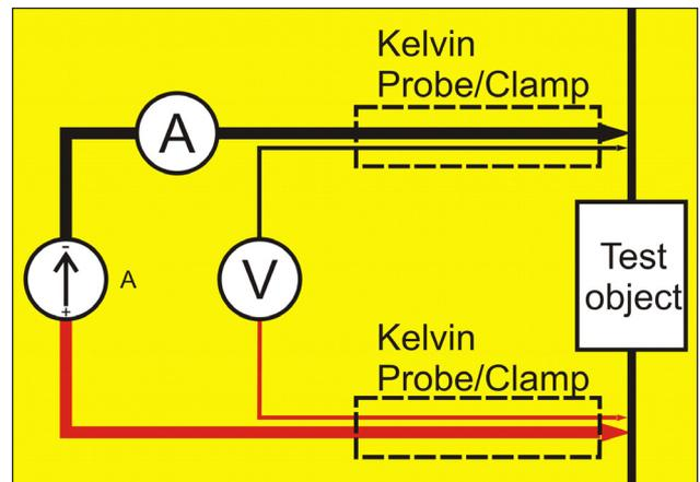
开尔文探头（包含在BD-59090内）在4线开尔文测试中被使用。这是测试电阻连续性，确保所有接触和导线电阻得到补偿的方法，大大加强了测试的精度。每一个开尔文探头装有两个末端，一个用于产生电流，另一个用于测量微弱的电压存在。
