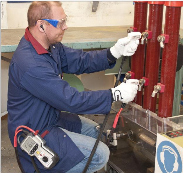
手持探头，将开尔文夹夹到断路器上，按下trig/TEST按钮。有一个信号指示测试通过或失败，测试结果被记录在仪器内，稍后可存储到电脑。
