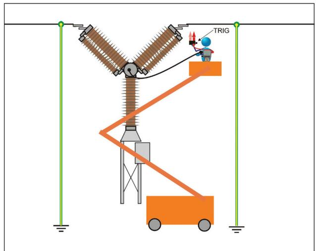
两端接地的断路器测试，双接地技术。
