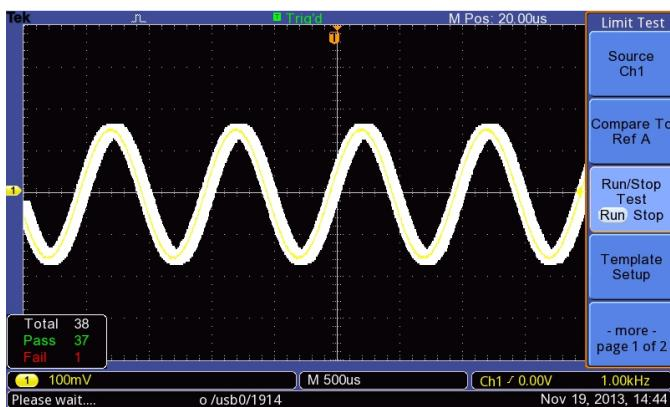
极限测试功能在触发的任何信号与用户自定义模板之间提供通过/失败快速对比。
