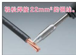
轻松焊接 22mm<sup>2</sup> 的铜线。
