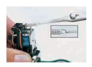
用于照明工程方面,Erem可提供特殊夹钩镊子。型号为940AS的可锁扣夹钩镊子能承受5公斤拉力并可以安全夹住细线。
