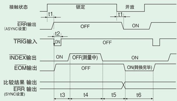
t1: 1.5ms(ERR输出响应时间) t2: 0.5ms min(测量触发脉冲幅)
