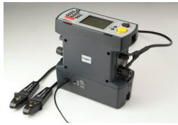
**DLRO10和DLRO10X也可以由可选的主电源装置DLRO10LPU供电。**该装置只需简单地安装到仪器上，代替标准电池组。
