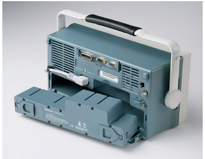
TDS3BATC 使用便携式电池最长可以连续工作三个小时。
