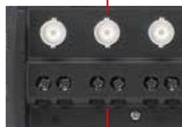
温度测量用M3螺丝接口
