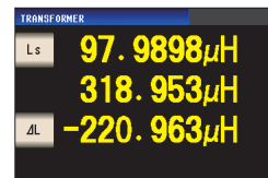
变压器测量模式 电感差测量界面
