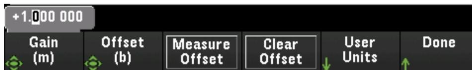
按 **User Units > User Units Off/On** 可显示 (On) 或关闭 (Off) 用户定义的测量单位。选择 **On** 将显示 Edit Units 软键所定义的单位；选择 **Off** 将显示默认单位 (VDC)。
