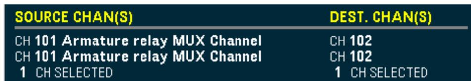
4. 按 **Copy Now**。系统会将通道 01 的测量配置复制到通道 02。操作完成时，将显示“COMPLETE”消息。按 **Copy Now** 以将相同的配置反复地复制到选定的新通道(通道 03、通道 04 等)。
