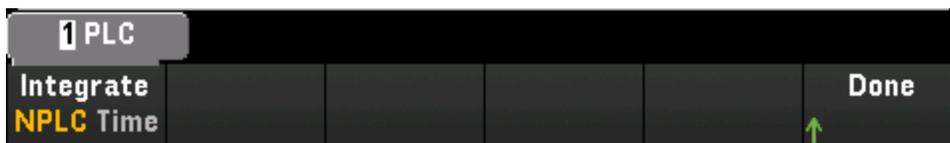
**NPLC** - 将积分时间设置为 0.02、0.06、0.2、1、2、10、20、100 和 200 个电源线路周期 (PLC)。只有 1 个 PLC 及更长的时间才能实现常模(工频噪声)抑制。如果选择 100 或 200 个 PLC，可实现最佳噪声抑制和分辨率。
