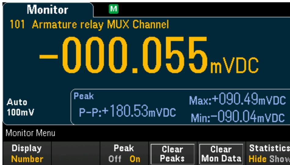
按 **Peak** 可启用 (On) 或禁用 (Off) 在测量间隙内采集的“最小值”、“最大值”和“峰峰”的测量值。启用后，将显示 **Clear Peaks** 软键。按此软键可清除峰峰函数的累积历史记录，从而重置峰值读数。此设置也适用于条形仪表。
