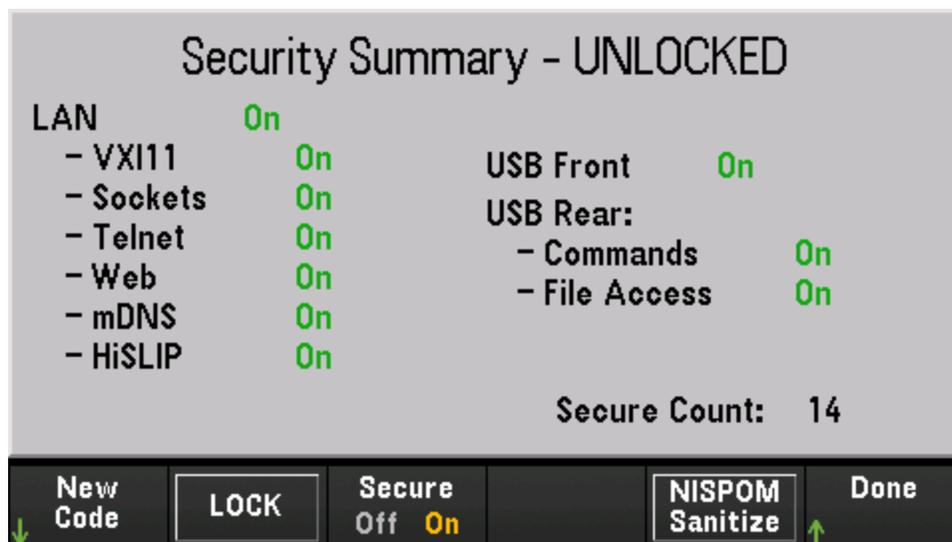
**New Code** - 按此软键可输入用于解锁仪器安全性的新安全代码。该代码必须以字母开头，最多可以包含 12 个字母、数字或下划线字符。
