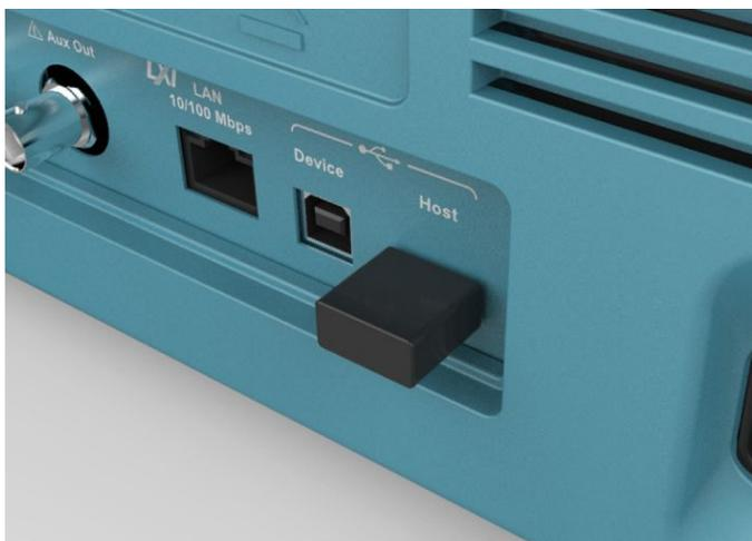
Wi-Fi 转接头通过集成设置菜单配置，支持无缝通信。
