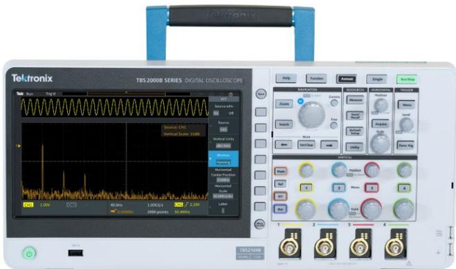
TBS2000B 系列示波器具有 9 英寸 WVGA 显示器，500 万点记录长度和 2 GS/s 采样率，可捕获和显示明显多得多的信号，帮助您更快地调试和验证设计。全新的波形上面光标读数和 32 种自动测量，使您能够简便地、满怀信心地分析信号，每种功能都拥有丰富的小贴士。TekVPI® 探头接口不仅支持传统无源 BNC 探头，还支持最新有源电压探头和电流探头，应用范围极广。
