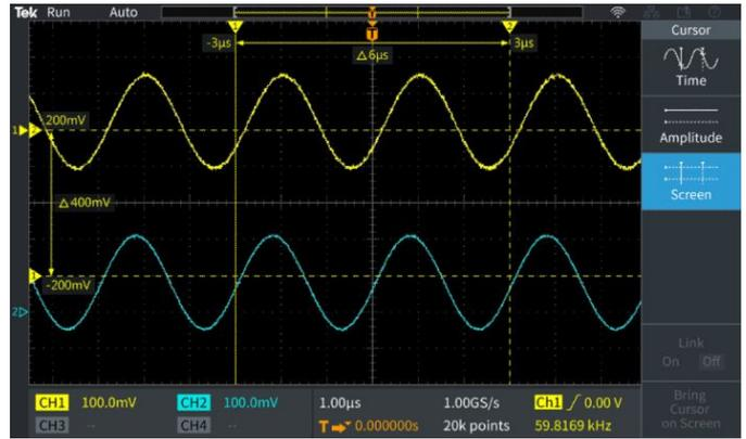
波形显示画面上显示光标读数。可以使用光标测量时间和幅度。
